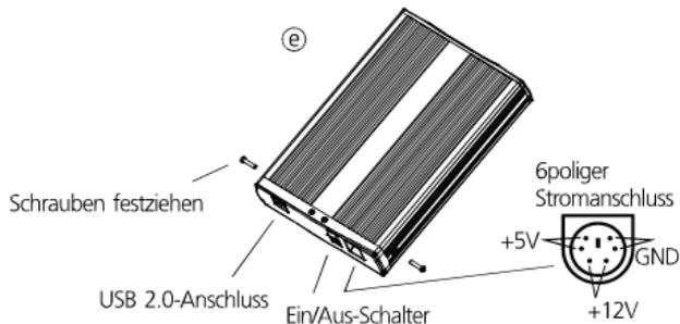
h) Schalten Sie nun das Gehäuse ein, sofern Sie über Windows ME/ 2000/XP, Mac OS ab Version 9.0 oder eine aktuelle LINUX-Distribution verfügen. Ihre Festplatte wird direkt nach dem Einschalten vom Betriebssystem automatisch erkannt.
